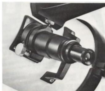
接眼鏡にはM42ネジが切っており、対光害μフィルターを装着することができた。左写真は、CX-FCLの試作機。40mmアイピースを用いれば、約48という望遠鏡としては驚異的な光明度(明るさ)を得られる。
